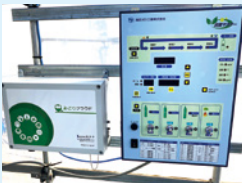
農業用炭酸ガス施用システムの制御装置
