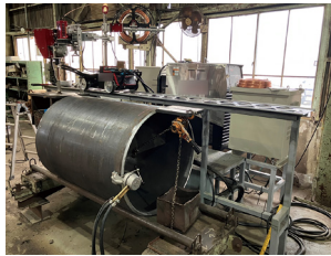
新規溶接機による厚板溶接
