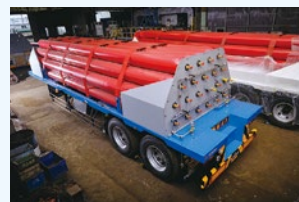
水素トレーラーカードル
